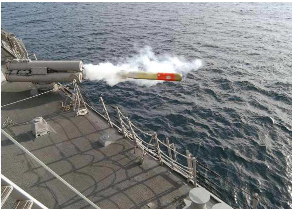
یک اژدرانداز مارک ۳۲ مد ۱۵ (SVIT) در حال پرتاب یک اژدر سبک وزن مارک ۴۶ مد ۵.
